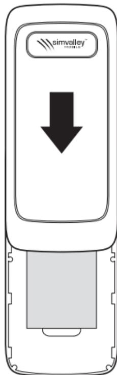
4. Setzen Sie die Abdeckung leicht nach oben versetzt auf das Mobiltelefon. Schieben Sie die Abdeckung dann mit leichtem Druck in Pfeilrichtung wieder fest.
