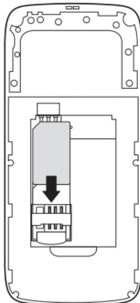
3. Setzen Sie die goldenen Kontakte des Akkus an die Kontaktstelle im Mobiltelefon.
