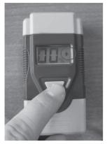
Drücken Sie die Taste einmal, um das Gerät einzuschalten. Das Gerät befindet sich jetzt im Holz-Messmodus.
