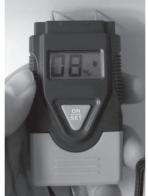
2. Öffnen Sie die Sensor-Abdeckung und stecken Sie das Gerät leicht in das Holz (Papier, Pappe). Das Display zeigt den Feuchtigkeitsgrad in Prozent an.
