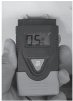
4. Stecken Sie den Sensor des Geräts leicht z.B. in eine Wand. Das Display zeigt den Feuchtigkeitgrad in Prozent an.
