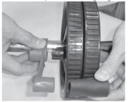
**Schritt 7** Stecken Sie nun die zweite Handkurbel auf die Achse, wie in der Abb. gezeigt.
