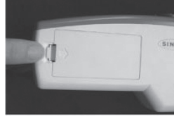
Lasche nach innen drücken und Deckel anheben
