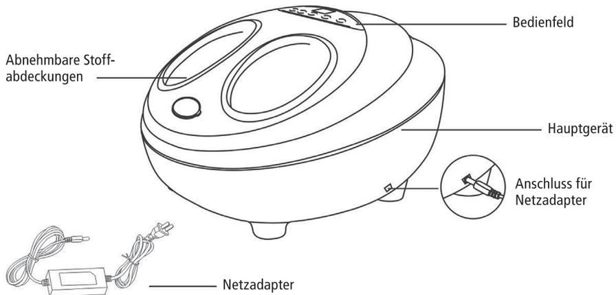
1. Das Bedienfeld: 5 voneinander unabhängige Tasten zum Betrieb und zur Funktionsauswahl des Geräts.
