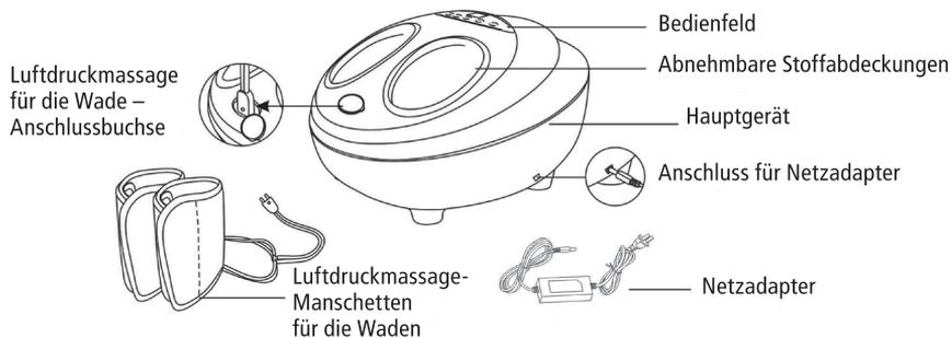
1. Das Bedienfeld: 5 voneinander unabhängige Tasten zum Betrieb und zur Funktionsauswahl des Geräts.
