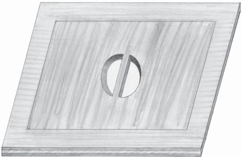
Ansicht: Beispiel eines Schablonenrahmens mit eingelegter Formschablone
