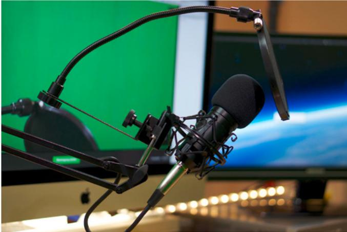
Studiomikrofon mit Spinne und Poppschutz am Mikrofongalgen (Bild: Hannes Schleeh)
