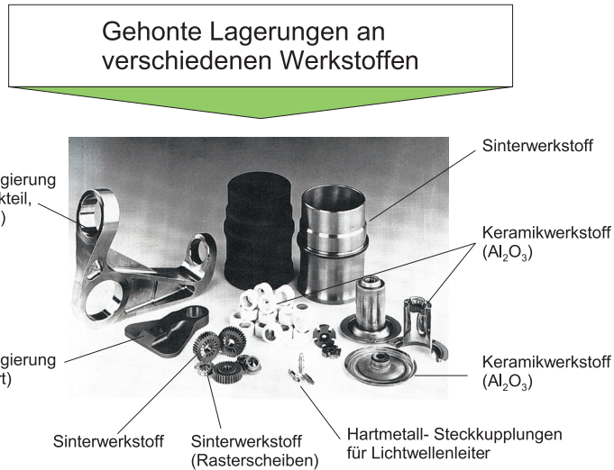
Abb. 99 Gehonte Lagerungen (nach Gehring und iht-Klink)
