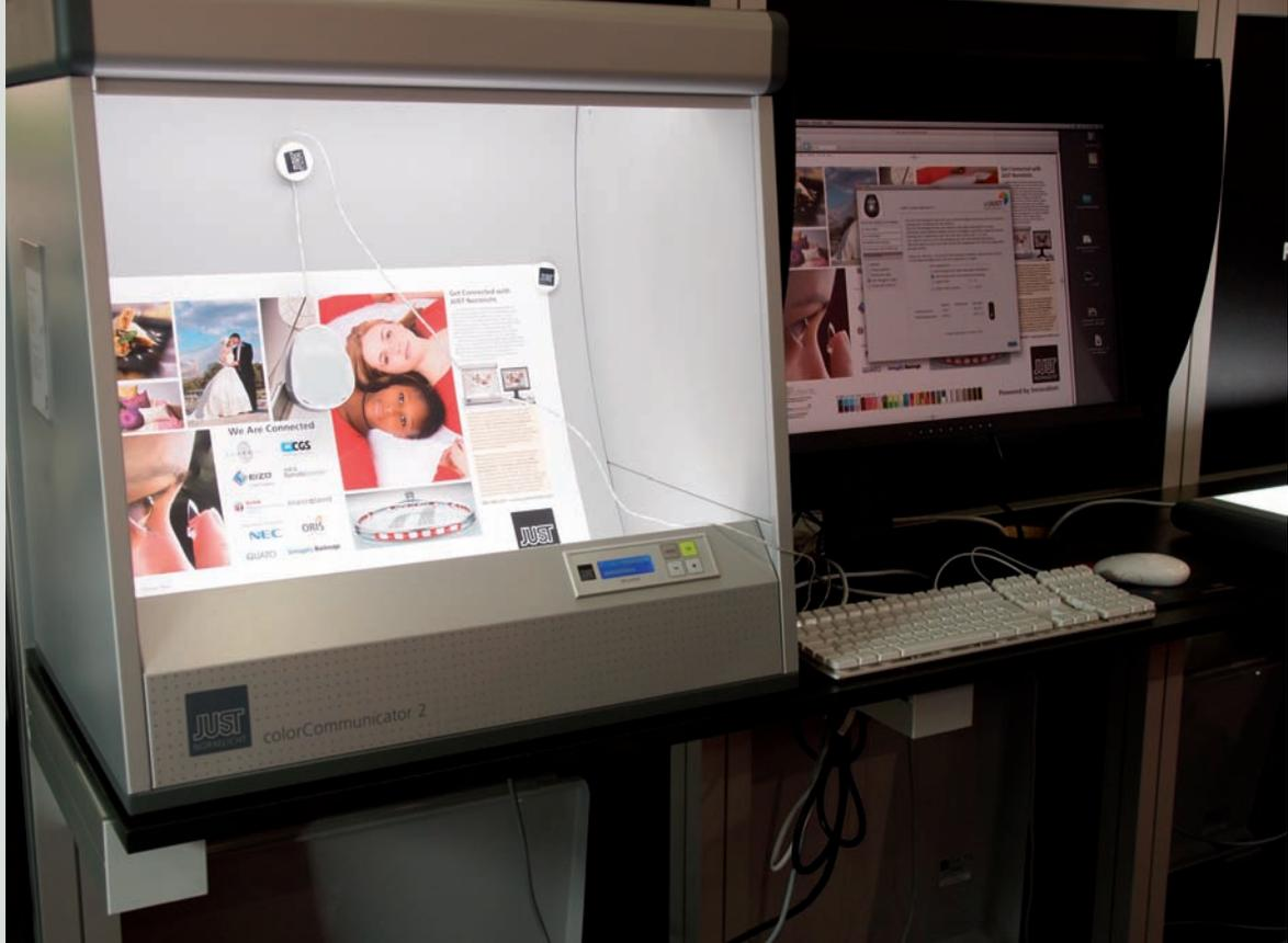
*Normlicht-Lichtkasten mit Helligkeitssteuerung über Sensor und USB.*
