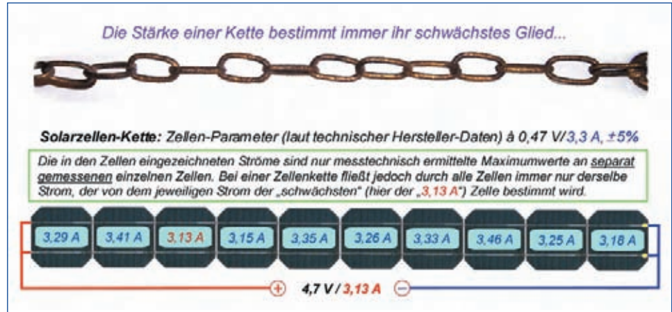
Abb. 8.2 – Der tatsächliche maximale Nennstrom, den eine Zellenkette liefern kann, wird durch die schwächste Zelle bestimmt, die z. B. in einem Solarmodul durch die Herstellungsstreuung in der Zellenreihe den niedrigsten Strom aufbringt
