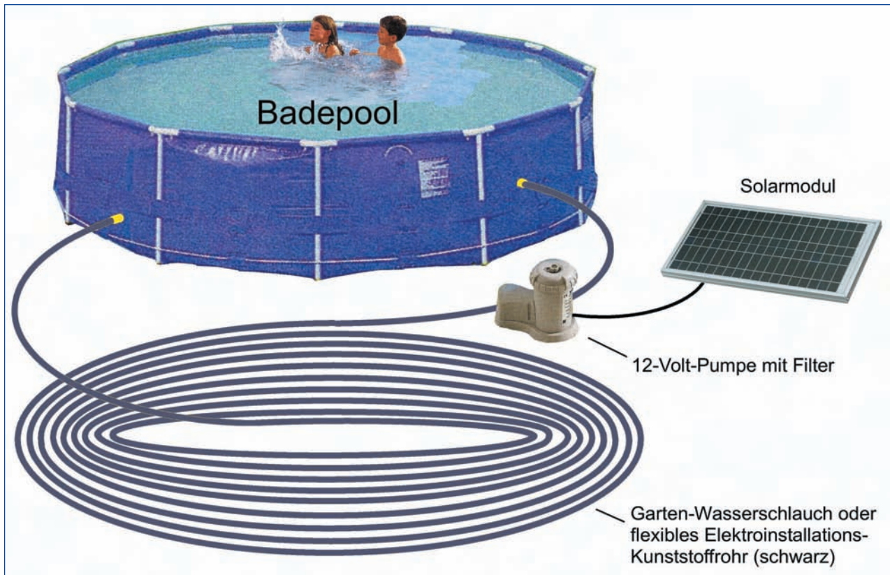
Abb. 3.7 – Badepools und Planschbecken erfreuen sich zunehmender Beliebtheit, sind sehr preiswert geworden und das Badewasser kann kostengünstig mit Hilfe eines einfachen „Sonnenkollektors“ Marke Eigenbau auch an etwas kühleren Tagen aufgewärmt werden
