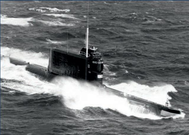
**RAKETENTRÄGER** Das in den späten 1950er-Jahren gebaute, dieselelektrisch angetriebene Sowjet-U-Boot der Golf-II-Klasse erreichte Geschwindigkeiten von 17 Knoten (31 km/h) über und 12 Knoten (22 km/h) unter Wasser. Es war mit drei nuklearen Kurzstrecken-Raketen mit einer Reichweite von 150 km bestückt.
