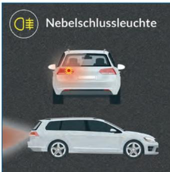
Nebelschlussleuchten haben eine wesentlich stärkere Leuchtkraft als die Schlussleuchten. Daher besteht allerdings auch die Gefahr, dass nachfolgende Fahrzeugführer dadurch geblendet werden. Aus diesem Grund darfst du die Nebelschlussleuchten nur bei starkem Nebel mit einer Sichtweite unter 50 m einschalten. Auf diese Weise werden bei starkem Nebel gefährliche Auffahrunfälle vermieden.
