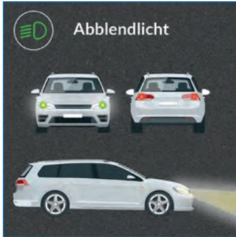
Das Abblendlicht wird über den Hauptschalter eingeschaltet. Neben den Lichtern, die mit dem Standlicht eingeschaltet werden, werden dann die Abblendlicht-Scheinwerfer angeschaltet.
