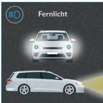
Ist das Abblendlicht eingeschaltet, kannst du mit dem Blinkerhebel das Fernlicht anschalten. Der Blinkerhebel muss dazu gezogen oder gedrückt werden. Das eingeschaltete Fernlicht erkennst du anhand der blauen Kontrollleuchte.
